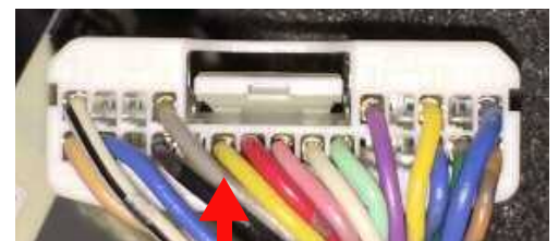
黄色線が信号線
